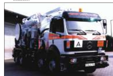
Spezialfahrzeug trennt Öl-Wassergemische am Einsatzort nach Ölunfällen
