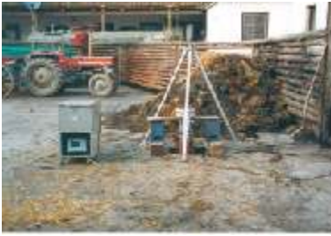
Foto 12: Messeinrichtung mit Druckaufnehmer (im Tauchrohr) und Permanentenschreiber
