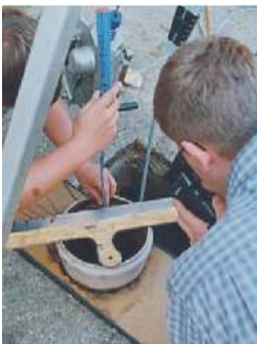
Foto 13: Abstichmessung mit Meterstab
