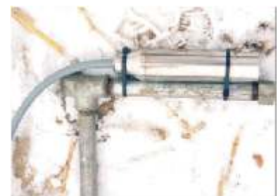
Foto 11: Druckmembrane (Membranfläche vertikal)
