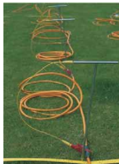
Abb. 1: Foto der Elektroden. Das sind Spieße aus Edelstahl, die je nach Art der Ansteuerung abwechselnd als Stromspeisungspunkte und als Punkte für die Spannungsmessung fungieren. Die Elektroden sind über ein mehradriges Spezialkabel mit der computergesteuerten Messapparatur verbunden.
