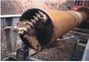
Bild 3: Präzisionsbohrgerät (hier mit Felschneidrad)
