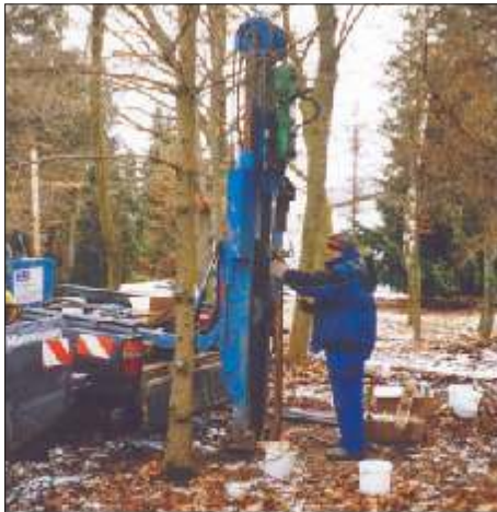
Abbildung 3: Während der umfangreichen Vorerkundungsmaßnahmen wurde neben der "klassischen" Baugrunderkundung durch Rammkernbohrungen (links) auch eine Erfassung und Beprobung der Gebäudesubstanz (links: Betonkernproben aus den Gebäudeböden) durchgeführt.
