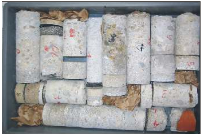
Abbildung 3: Während der umfangreichen Vorerkundungsmaßnahmen wurde neben der "klassischen" Baugrunderkundung durch Rammkernbohrungen (links) auch eine Erfassung und Beprobung der Gebäudesubstanz (links: Betonkernproben aus den Gebäudeböden) durchgeführt.
