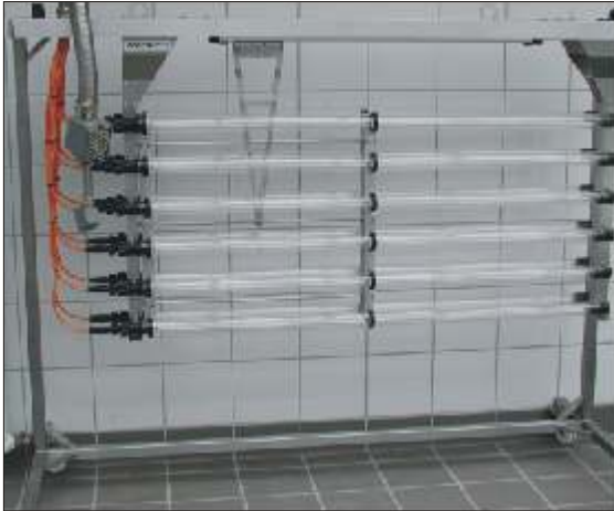
Bild 6: Ein Modul auf dem Servicewagen
