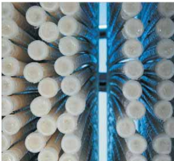
Abb. 4: Feinste Filter für die Hygienisierung. Kapillarmem- branen bilden in großer Zahl ein Modul, das sauberstes Wasser abzieht. Bild: Mall
