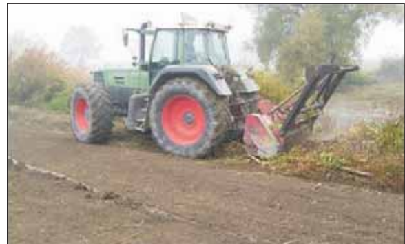
Abb. 7: Einsatz des Forstmulchgeräts
